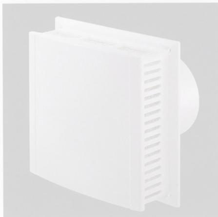
te Frischluftzufuhr, auch bei geschlossenen Fenstern, überzeugt insbesondere durch seine intelligente Luftverteilung, seine hohe Schalldämmung und die Filterung der hereinströmenden Aussenluft. Zur Vermeidung von Zuglufterscheinungen wurde «Aerocube» ausserdem mit einer manuell bedienbaren Drosselklappe und einer Winddrucksperrung ausgestattet. Als Bohrung für die einfache Montage wird eine 15 cm grosse Öffnung in der Aussenwand benötigt.
